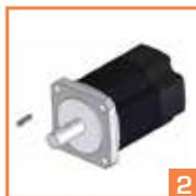
Remover a chave do eixo do motor, verificando se o diâmetro confere com o do redutor.
