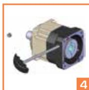
Retire o parafuso que está na carcaça do redutor, após afrouxe o parafuso que prende o eixo.
