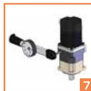
Aperte o parafuso do eixo com a chave e o torque adequados. Verifique o torque indicado na Tabela de Torques de Aperto.
