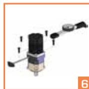
Aperte os parafusos que acoplam o motor no redutor em ordem, utilizando o torque adequado.
