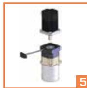
Coloque o motor no redutor verticalmente, mantendo a chave no parafuso do eixo.
