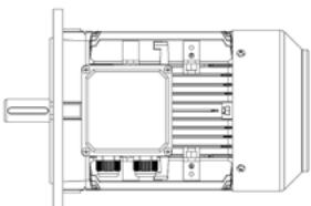
Não é recomendado acionar o redutor com rotações elevadas na entrada, como ocorre com motores de 2 polos (considere apenas se a aplicação for intermitente). O uso acima de 1800 rpm resultará em aumento excessivo da temperatura.
