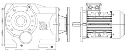
O acoplamento do conjunto motorredutor deve ser livre e deslizante, recomenda-se o uso de graxa grafitada para lubrificação do eixo antes da montagem no redutor, com objetivo de facilitar desmontagens futuras.
