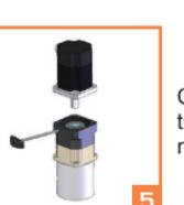
Coloque o motor no redutor verticalmente, mantendo a chave no parafuso do eixo.
