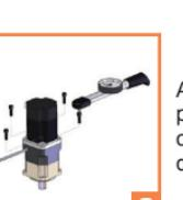
Aperte os parafusos que acoplam o motor no redutor em ordem, utilizando o torque adequado.
