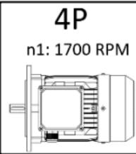
Recomenda-se que não seja utilizado controlador de velocidade, pois velocidade maior que a rotação nominal do motor pode resultar em sobreaquecimento e danos ao redutor.
