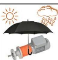
Recomenda-se que o motoredutor seja instalado em ambiente com proteção de intempéries. Não recomenda-se a intalação ao ar livre, ambientes agressivos devido à salinidade, ou a elementos químicos.
