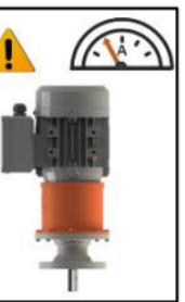
Após instalação, sempre realizar o teste de arranque, controlando a potência absorvida através da medição da corrente elétrica do motor instalado ao redutor. Caso seja observada ocorrência de vibração, ruído ou percebido qualquer anormalidade, desligue o equipamento imediatamente e entre em contato com a Redutores IBR.
