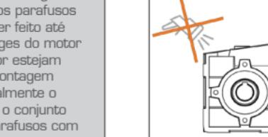
Caso for pintar o redutor, proteja as partes usinadas e os retentores, evitando que tenham contato com a tinta.
