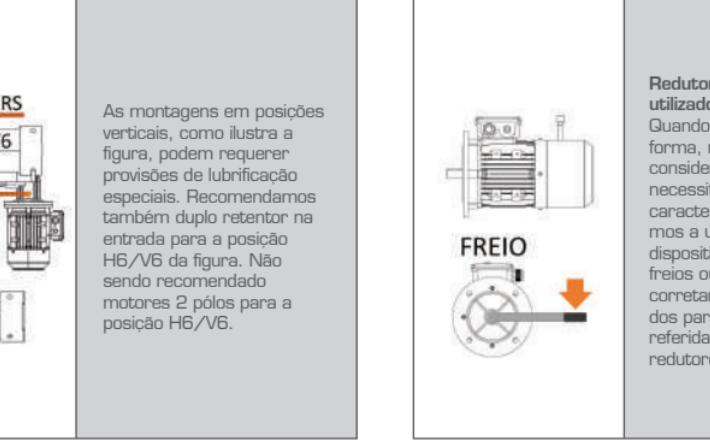
As montagens em posições verticais, como ilustra a figura, podem requerer provisões de lubrificação especiais. Recomendamos também duplo retentor na entrada para a posição H6/V6 da figura. Não sendo recomendado motores 2 pólos para a posição H6/V6.
