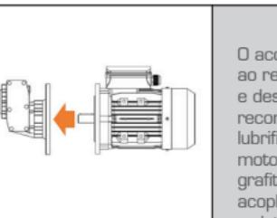
O acoplamento do motor ao redutor deve ser livre e deslizante, recomenda-se a lubrificação do eixo do motor com graxa grafitada antes do acoplamento com o redutor, facilitando futuras desmontagens.
