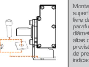
Monte o redutor sobre superfície rígida, plana e livre de vibrações. Utilize parafusos de maior diâmetro possível. Se altas cargas são previstas, utilizar arruela de pressão, conforme indicado na figura.
