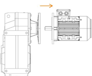
O acoplamento do conjunto motorredutor deve ser livre e deslizante, recomenda-se o uso de graxa grafitada para lubrificação do eixo antes da montagem no redutor, com objetivo de facilitar desmontagens futuras.
