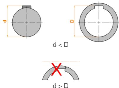
Ao montar itens no eixo vazado do redutor, recomenda-se o uso de graxa grafitada para lubrificação do eixo antes da montagem no redutor, com objetivo de evitar gripagem e oxidação. Verifique as medidas da chaveta e do eixo maciço, garantindo a conformidade com as tolerâncias e o alinhamento adequado para a montagem do conjunto.
